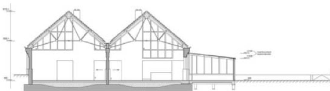
Dwarsdoorsnede met bijzondere spant- en mestgootconstructie
